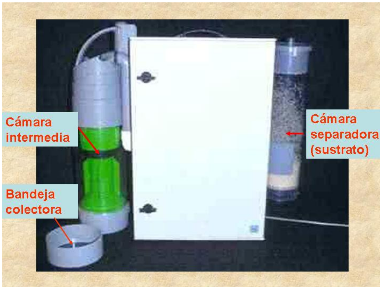
Fig. 17. Equipo cosechador de esporas Mycoharvester (MH-1) separando esporas de Beauveria bassiana desarrollada sobre arroz.
