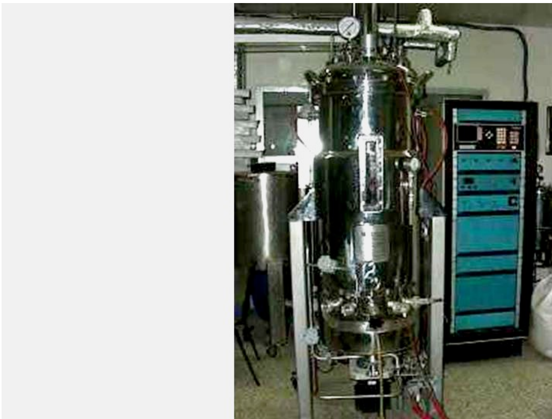
Fig. 10. Fermentador de 100 L para el desarrollo de inóculo de Trichoderma harzianum para sustrato sólido (sistema bifásico) en Cuba o para producción líquida de conidios y blastosporas. Nótese a la derecha en azul la pizarra controladora del proceso.
